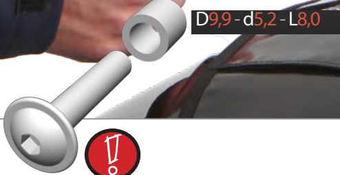
Linsenflanschschraube lens head screw M5x20 4NM Drehmoment Torque
