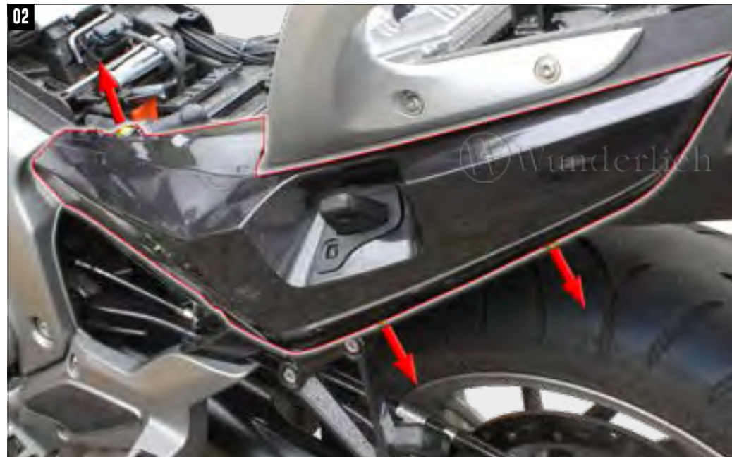
K 1600 GTL Seitenverkleidung demontieren! Dismount the side panel!
